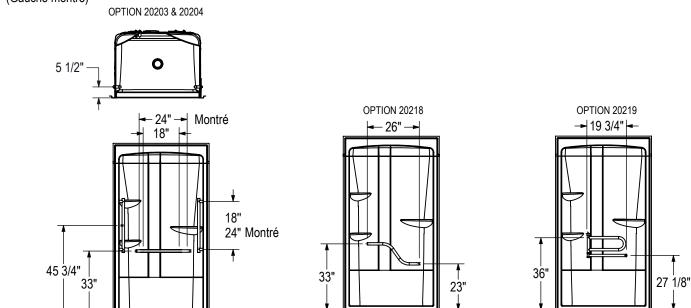
Toutes ces dimensions sont approximatives. Afin d'assurer une installation parfaite, les dimensions de la structure doivent être vérifiées à partir de l'unité.
