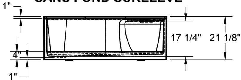
Toutes ces dimensions sont approximatives. Afin d'assurer une installation parfaite, les dimensions de la structure doivent être vérifiées à partir de l'unité.
